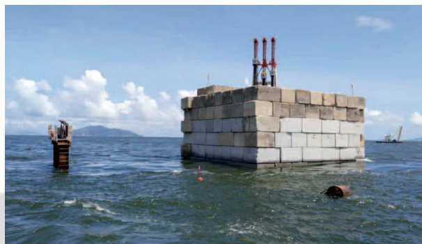
深層水泥攪拌樁現場靜載試驗現場
