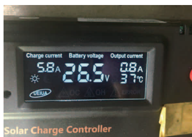
太陽能充電控制器，可以顯示充電電流，電池電壓和放電電流。
