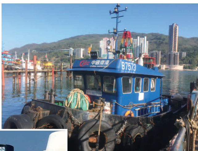
電控搖擺左右上下LED搜索射燈，可照射至50米遠。
