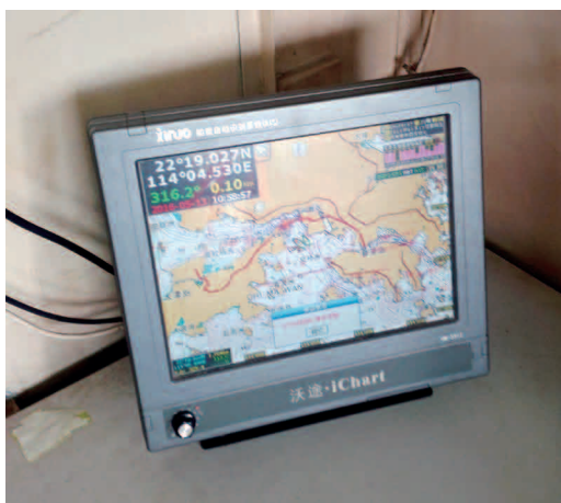
疏浚船上安裝了船隻自動識別系統及天線
