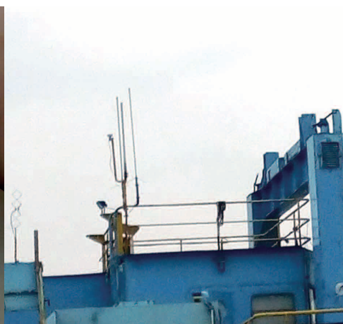
疏浚船上安裝了船隻自動識別系統及天線
