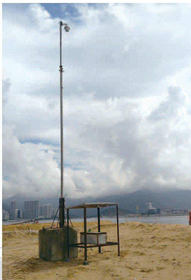
安裝在人工島上的攝像頭，內置太陽能發電、電池和WIFI等設備，白天太陽能可以給電池充電，充滿一次電可以給設備連續使用3-5天
