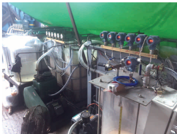
與項目部合作使用模型箱來做膨潤土試驗。
