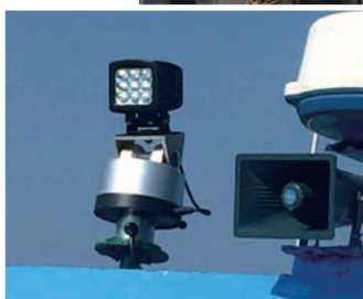
電控搖擺左右上下LED搜索射燈，可照射至50米遠。
