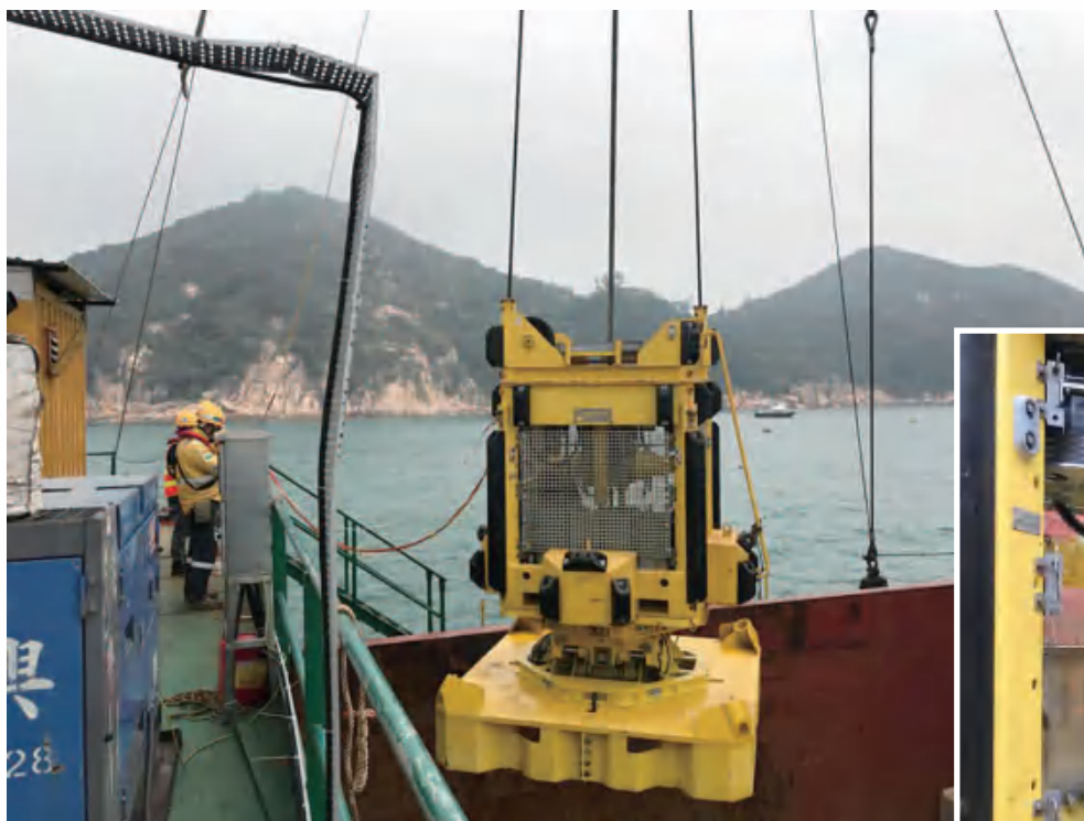
吊Manta主機至海底及回船艙
