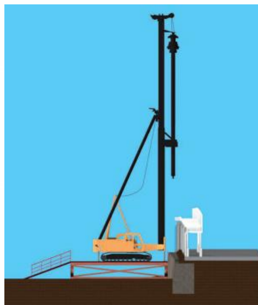
圖九：鋼板樁安裝斷面圖 (BIM模型)
