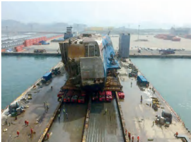
圖6 重約17000噸「世越號」沉船轉運上岸 （圖片來源於www.marineinsight.com）
