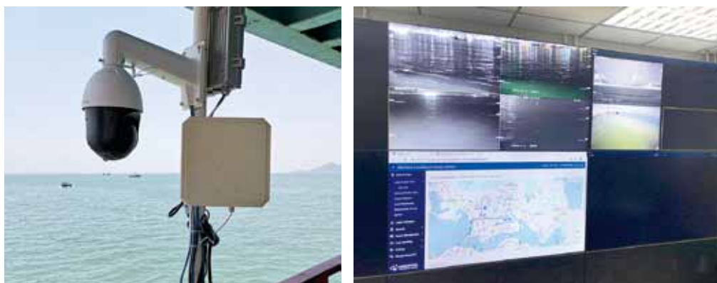
鏡頭採用4G網絡傳輸數據(左)；控制中心實時顯示現場畫面(右)。
